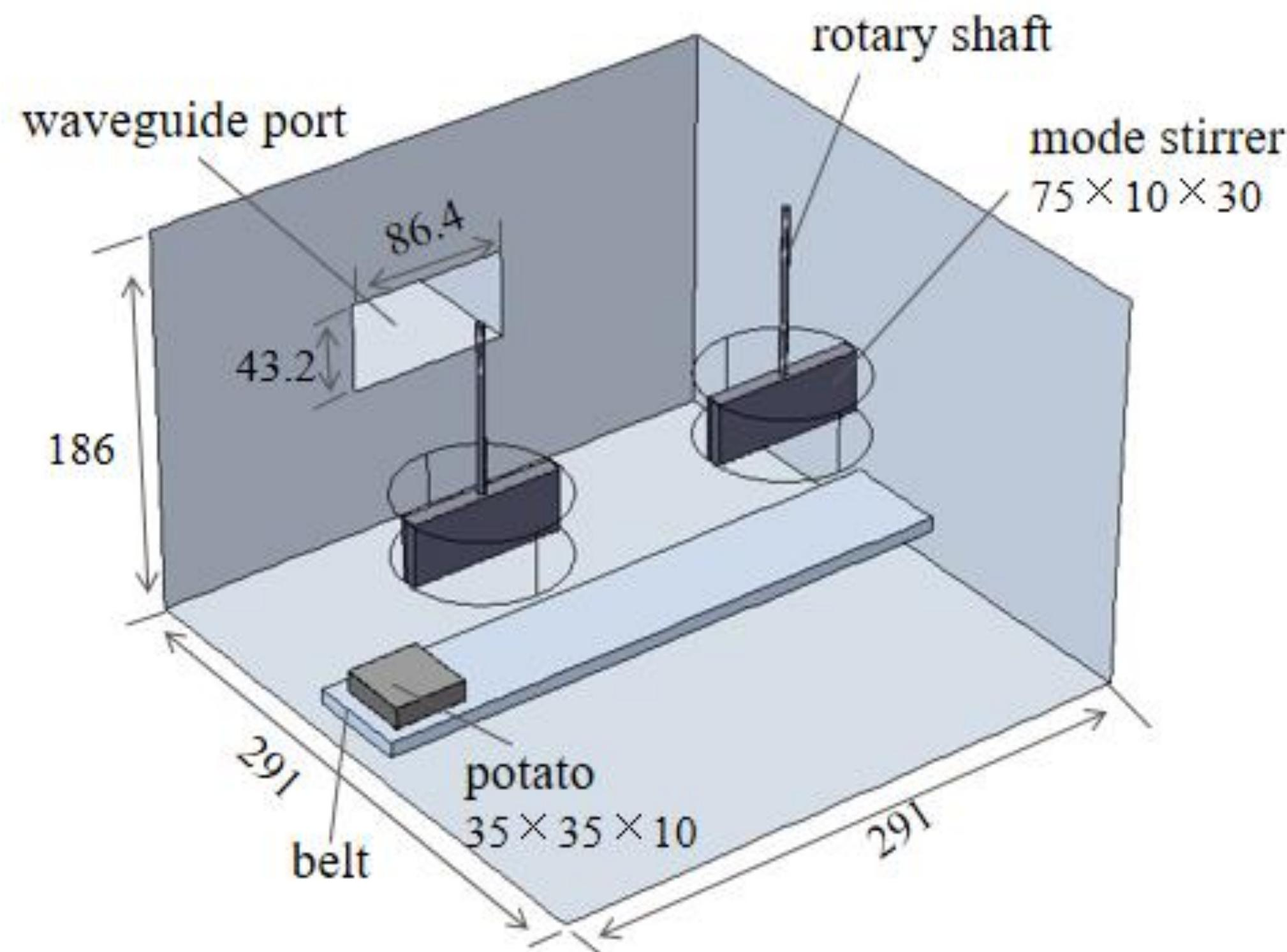
图1. 模型结构 (单位: mm)
