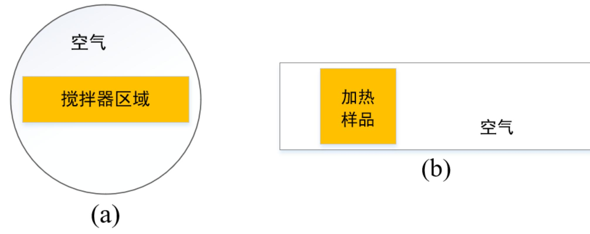
图2. (a)模式搅拌器旋转区域, (b)加热土豆运动区域
